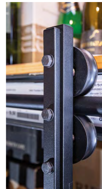
Pulverbeschichtung von Industrieleitern Powder Coating of industrial ladder
